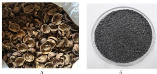
Рисунок 5 – Процесс извлечения активированного угля из скорлупы грецкого ореха (а – скорлупа грецкого ореха до обугливания; б – активированный уголь после карбонизации)
