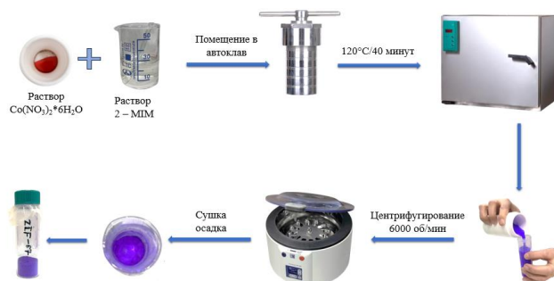
Рисунок 2 – Схема гидротермального синтеза ZIF-67
