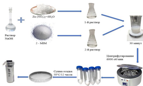
Рисунок 1 – Схема синтеза ZIF-8 при комнатной температуре
