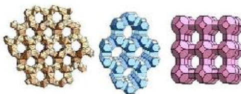
Сурет 2 – Цеолиттердің каркасты құрылымдары
