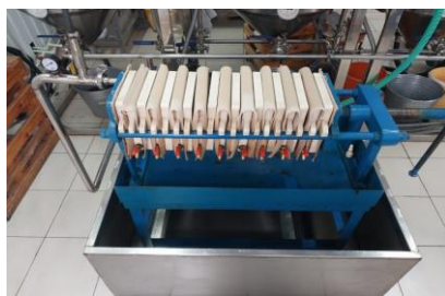
Сурет 5 – Өсімдік майына арналған рамалы сүзгі-пресс
