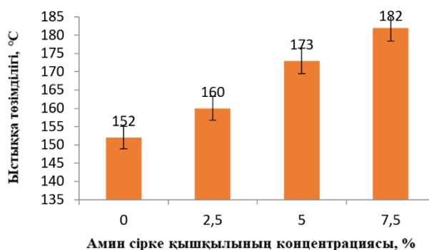
Сурет 11 – Құрамында 0,05 масс.б. AlN бар эпоксидті композиттің ыстыққа төзімділігінің амин сірке қышқылының концентрациясына тәуелділігі
