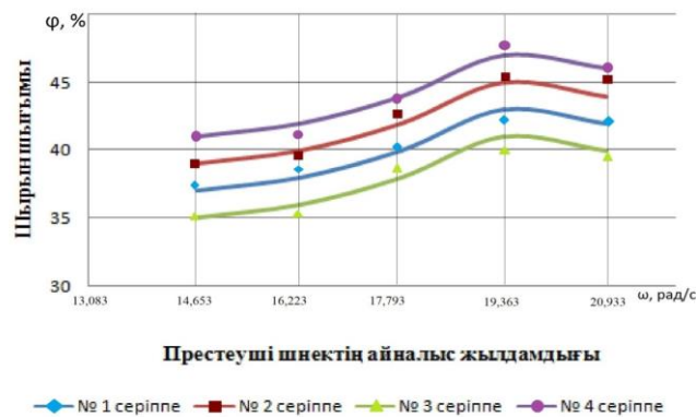
2 сурет – Шырғанақ шикізатын престеуде шырын шығымының қысымды реттеу серіппесінің құрылмасы мен айналыс жылдамдығына тәуелді өзгерісі
