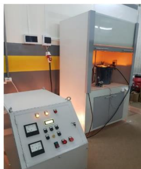
Рисунок 1 – Внешний вид и принципиальная схема установки ЭПУ: 1 – заготовка (образец); 2 – конусный электролизер из нержавеющей стали; 3 – отстойник; 4 – насос; 5 – электролит; 6 – электролитная ванна
