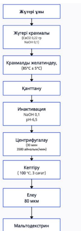
Сурет 1 – Жүгері ұнынан мальтодекстрин алу технологиясы
