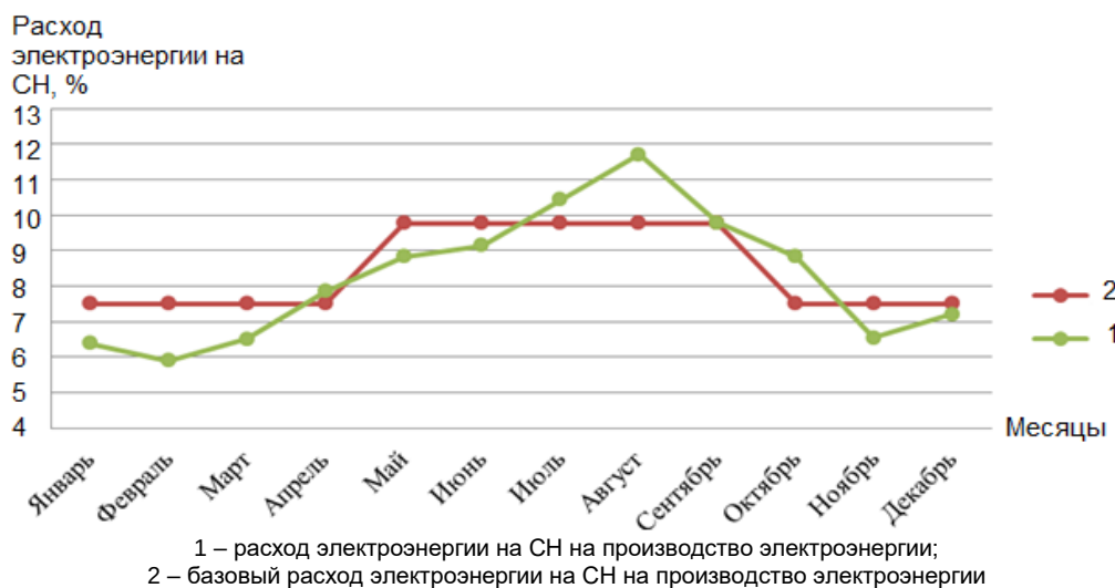
Рисунок 4 – Расход электроэнергии на собственные нужды
