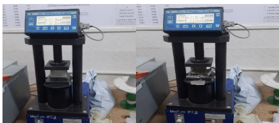
Рисунок 5 – Исследование образцов на сжатие
