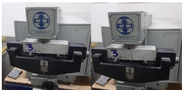
Рисунок 4 – Определение прочности на изгиб
