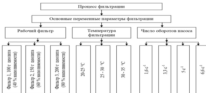
Рисунок 2 – Технологическая схема фильтрации молока
