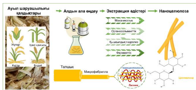
Сурет 1 – Ауылшаруашылық қалдықтарынан наноцеллюлоза алудың технологиялық схемасы: алдын ала өңдеу, экстракция әдістері және алынатын наноцеллюлоза өнімі
