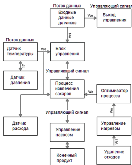
Рисунок 1 – Блок-схема АСУ процесса извлечения сахаров.
