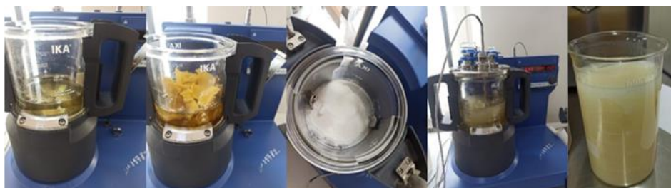
Рисунок 1 – Технологический процесс структурирования подсолнечного масла различными структурообразователями
