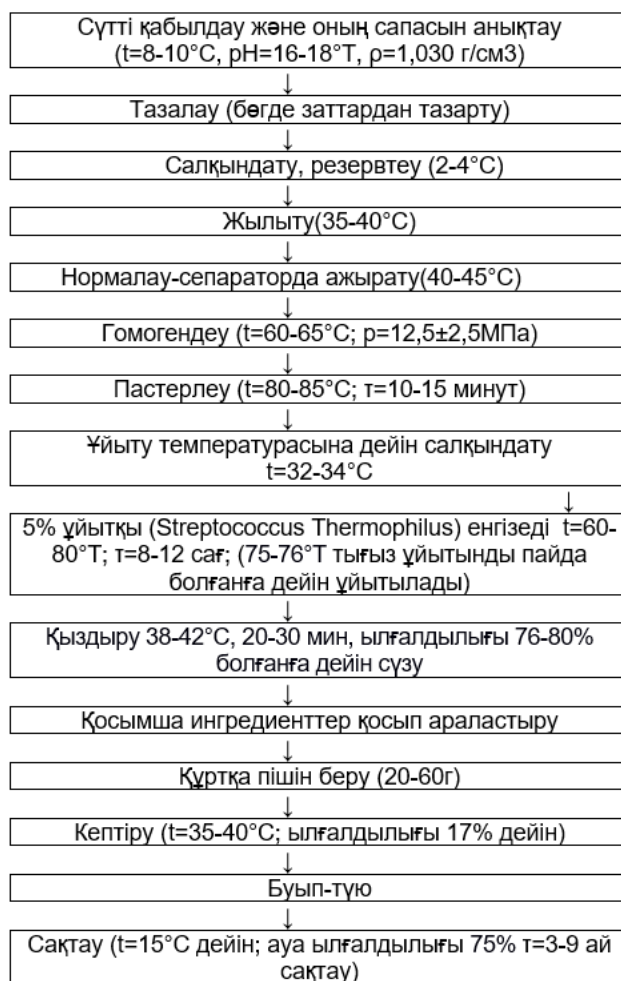
Сурет 1 – Кептірілген өрік қосылған құрт өндірісінің технологиясының сұлбасы
