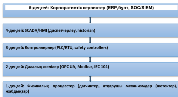
Сурет 2 – КФЖ-ның эталондық архитектурасы (1-5 деңгейлер) және деректердің екіжақты алмасуы каскадты тәуекелдердің көзі ретінде
