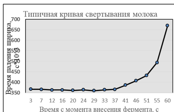
Рисунок 3 – Кривая зависимости времени падения шарика от продолжительности времени с момента внесения фермента
