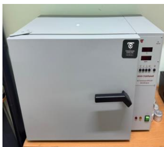
Рисунок 4 – Сушильный шкаф ШС-40-02 для определения влажности початков кукурузы и зерна
