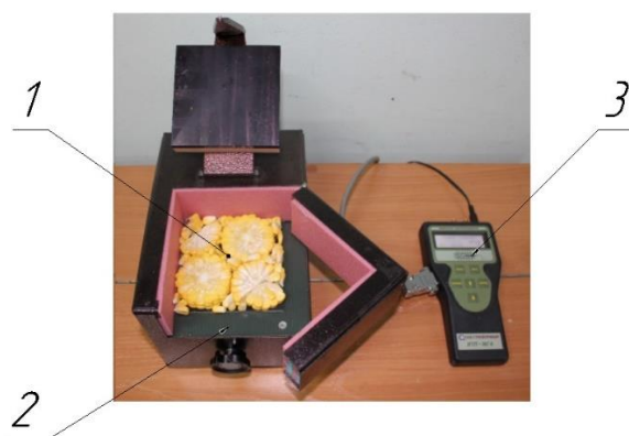
Рисунок 2 – Общий вид измерительного прибора ИТП-МГ4 «100»
