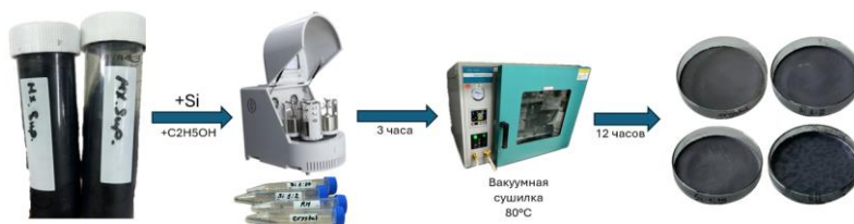
Рисунок 1 – Схематическое изображение процесса синтеза нанокомпозитов
