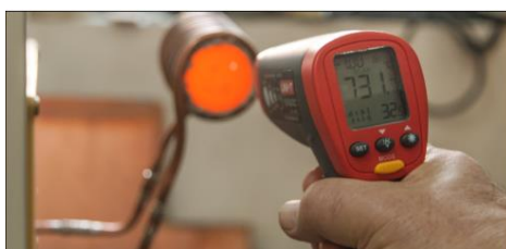
Сурет 5 – Металды 731°C температураға дейін индукциялық қыздыру процесі Тәжірибе барысында трансформатордың бастапқы тізбегінде конденсаторсыз инвертор
