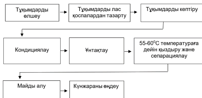
Сурет 1 – Қауын мен асқабақ тұқымдарынан май алудың технологиялық схемасы
