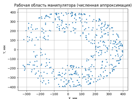
Рисунок 5 – Рабочая область манипулятора
