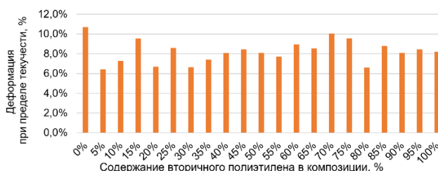
Рисунок 9 – Влияние содержания вторичного полиэтилена на деформацию при пределе текучести (%) ротационных композитов
