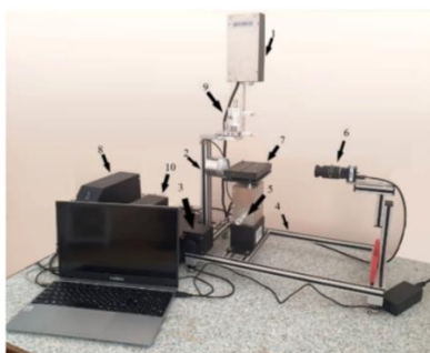
Рисунок 1 – Прибор для определения краевого угла смачивания ACAM
