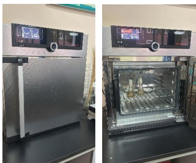
Рисунок 7 – Этап выдержки и сушки экомыла в термостатируемых условиях с применением термостата Memmert IN с TFT-дисплеем
