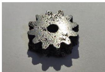
Рисунок 3 – Шестерня распечатанная на экспериментальной лабораторной аддитивной установке SLM
