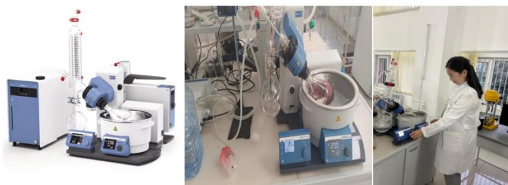
Сурет 2 – IKA RV-10 роторлы буландырғыш көмегімен қара шетен жемістерінен концентрат алу
