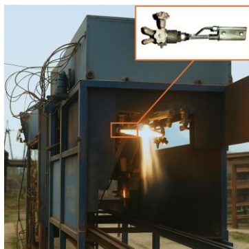
Рисунок 3 – Производственная линия для нанесения покрытий. В масштабе вынесена огнеструйная горелка ракетного типа
