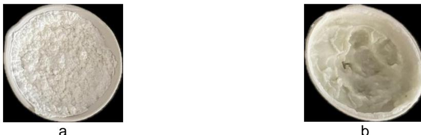
Рисунок 2 – Внешний вид сульфоаммофоса, полученного из ЭФК концентрации: а – 19-35%, б – 39%
