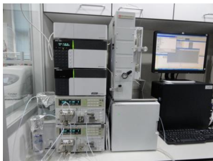
Сурет 1 – Жоғары тиімді сұйықтық хроматографы (ЖТСХ)
