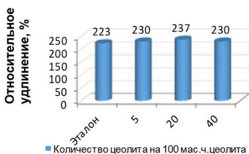
Рисунок 5 – Диаграмма зависимости относительного удлинения от содержания цеолита
