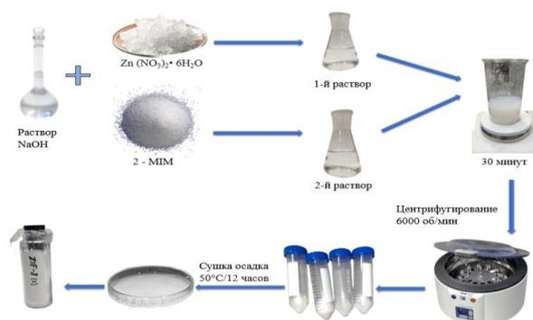
Рисунок 1 – Схема синтеза ZIF-8 при комнатной температуре
