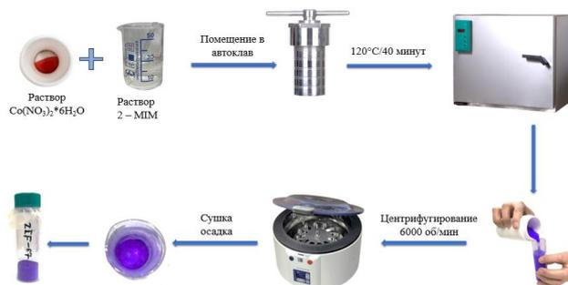
Рисунок 2 – Схема гидротермального синтеза ZIF-67
