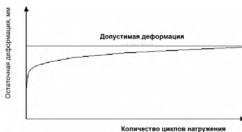
Рисунок 1 – Изменение необратимой деформации при повторных нагрузках
