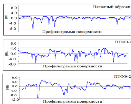
Рисунок 7 – Профилограммы поверхности образцов ПТФЭ
