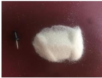
Рисунок 1 – Проппант из супер песка
