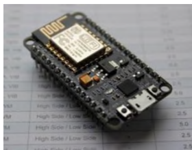
Рисунок 1 – Питание и интерфейс подключения к ПК: Micro-USB
