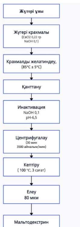
Сурет 1 – Жүгері ұнынан мальтодекстрин алу технологиясы
